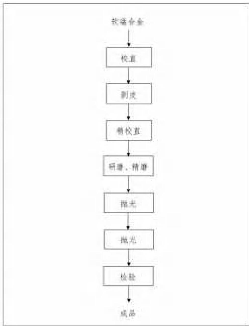
图 2.8-4 生产工艺流程图
